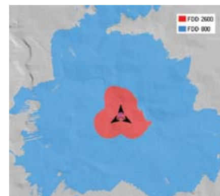
Рис. 6 Сравнение радиопокрытия трехсекторной БС в диапазонах 2600 и 800 МГц
