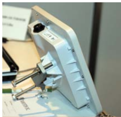
Стационарное клиентское устройство, WiMAX для диапазона радиочастот 2,4 ГГц.
